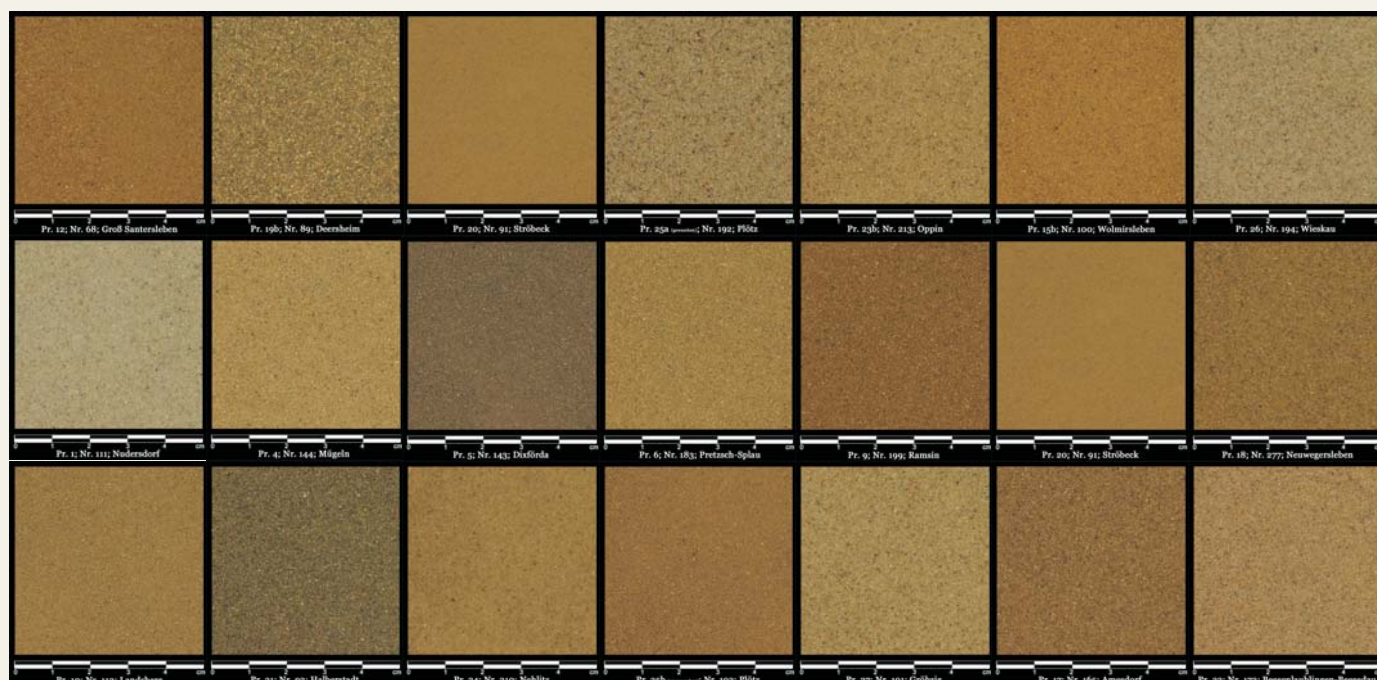
Auswahl verschiedenfarbiger Sande, abgeseibte Feinanteile < 0,5 mm
