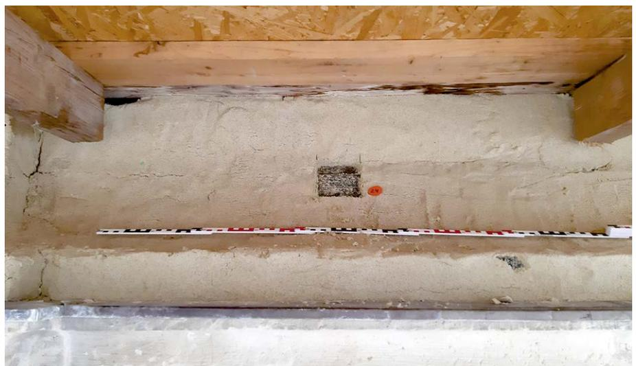
(9) Kompressenauflage auf Gesimsstück mit Probenahmestelle für Kompressenuntersuchung
